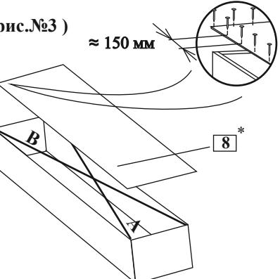
В накладку ящика вворачивается дибель эксцентриковой стяжки. Ящик складывается согласно схеме, в паз вставляется дно, накладка стягивается с корпусом ящика. **Предварительно просверлив отверстия Ø 2,5 мм**, крепят направляющие шурупами 4x13. Шурупом 4x16 через фиксатор приворачиваем дно ящика (рис. №6)
